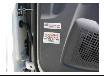
FIT TILT CAB WARNING LABEL TO DRIVERS SIDE DOOR AS SHOWN
