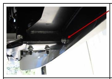
REMOVE NUT, ONE (1) PER SIDE PASSENGER SIDE SHOWN
